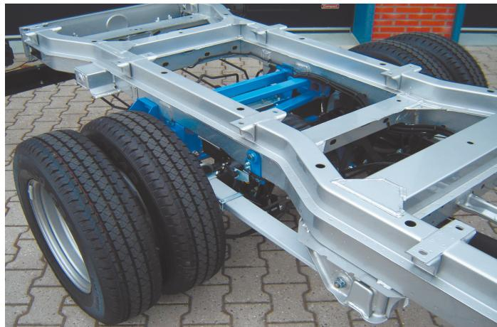
Der Mercedes-Benz Sprinter 5,0 T 4x4 ist auch verfügbar mit Luftfederung auf der Hinterachse. Der Sprinter eignet sich aus technischer Sicht hervorragend für die Ergänzung mit einem Luftfederungssystems. Die bei VB-Airsuspension entwickelte Hinterachsluftfederung ist als Nachrüstlösung verfügbar für neue und gebrauchte Fahrzeuge. Unsere VB-FullAir-2C Vollluftfederung ist zu beziehen über die VB-Partner und über die Mercedes-Benz Händlerorganisation.
