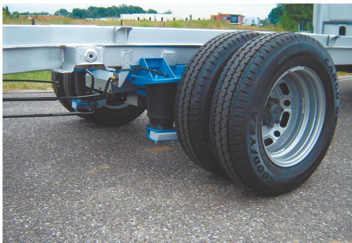
Der Mercedes-Benz Sprinter wird für eine breite Skala von Einsatzbedingungen verwendet. Für die Personenbeförderung, Behinderten Transport, Rettungsfahrzeuge, Wohnmobile. Sowie Fahrzeuge für Autotransport und für stoßempfindlichen Produkten, ist Luftfederung erforderlich. Unsere VB-FullAir-2C Vollluftfederung bietet für diese und andere Einsatzbedingungen eine passende Lösung
