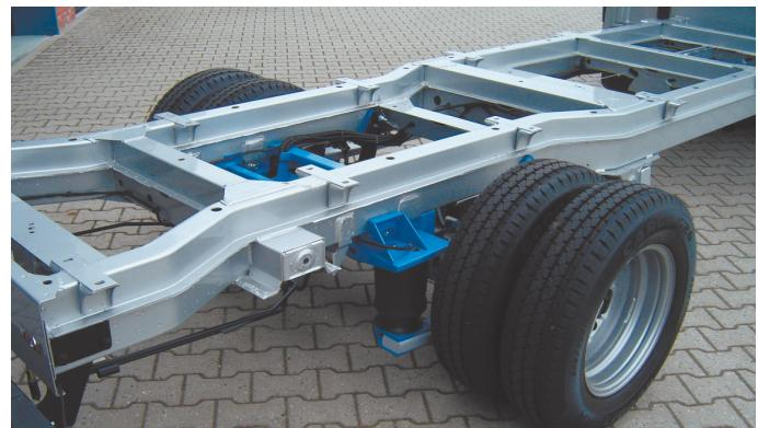
Die Steuerung der hinterach Luftfederung ist kompatibel mit der Mercedes-Benz Fahrzeugelektronik.
