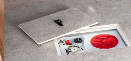
5 Apertura per pulizia serbatoio acque chiare
