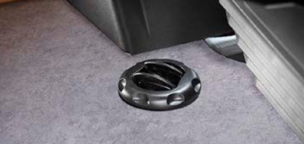
1 Presa d'aria calda aggiuntiva
