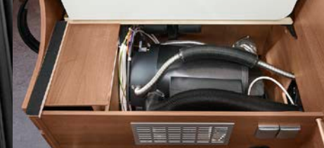
4 Riscaldamento diesel zona giorno
