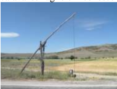
Pozzo a bilancia
