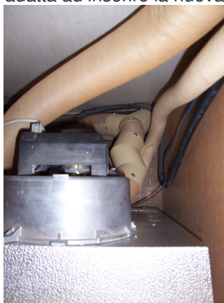
vano stufa visto dall'alto: sulla destra il raccordo con inserito il nuovo tubo
