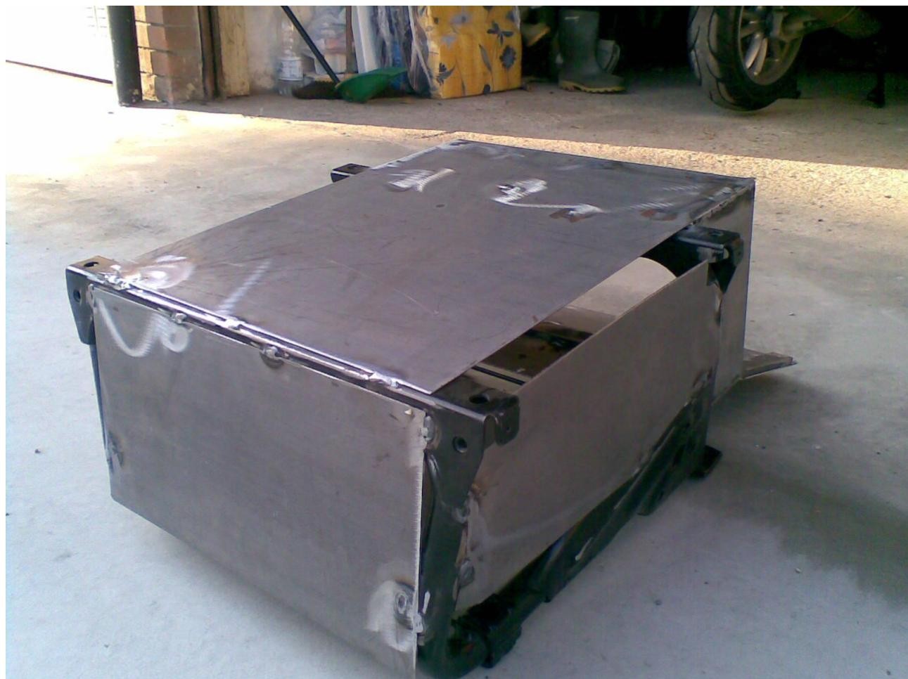
FOTO 2: vista all'interno, dopo aver saldato la lamiera , per realizzare lo sportello ho saldato 2 cerniere ed ho rinforzato la struttura saldando delle bacchette di ferro rettangolare 1 x 2 cm, che hanno la funzione di battuta per lo sportello
