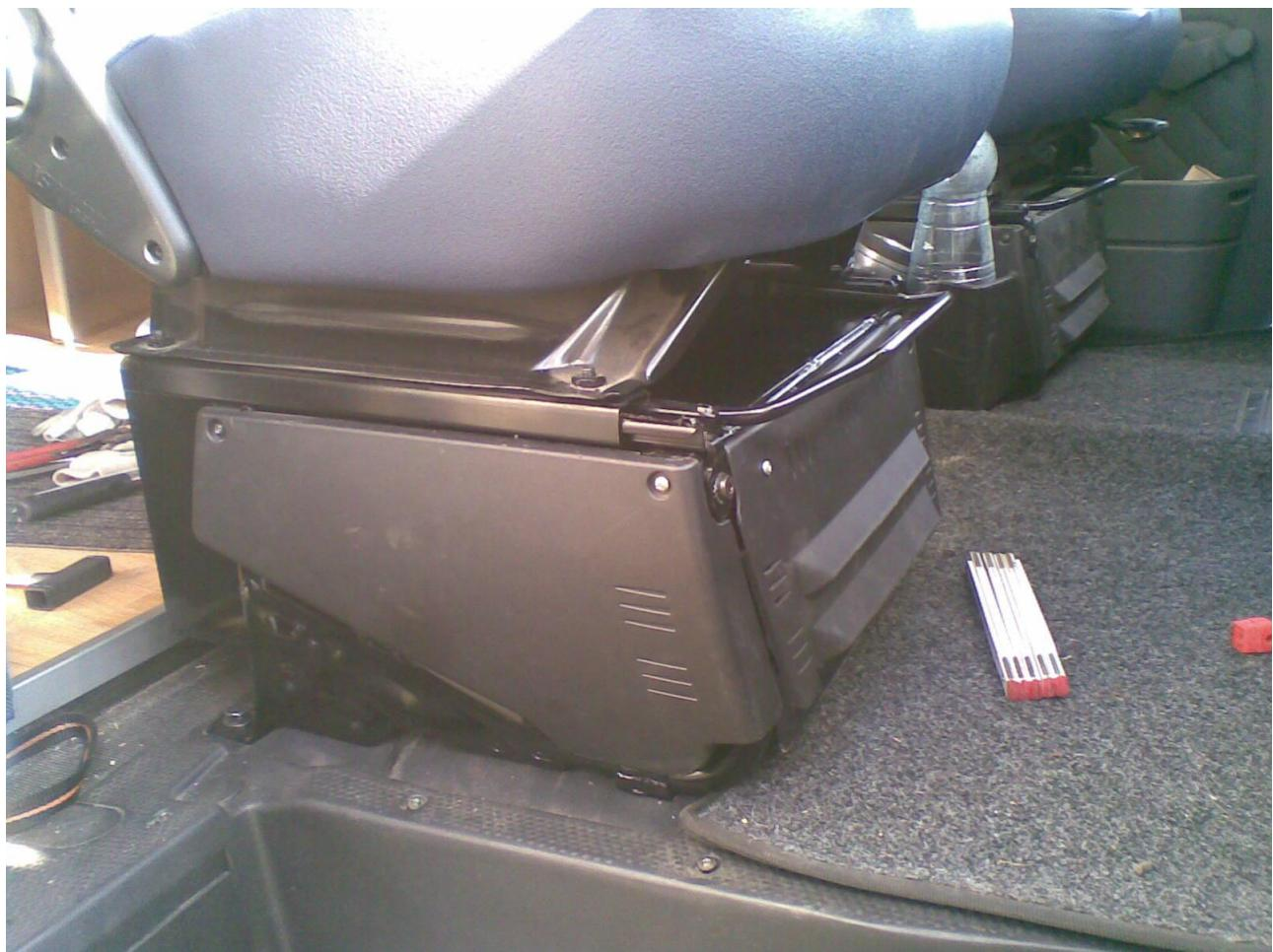
per finire ho fissato il sensore volumetrico dell'antifurto con il velcro adesivo e 2 viti con dado per sicurezza
