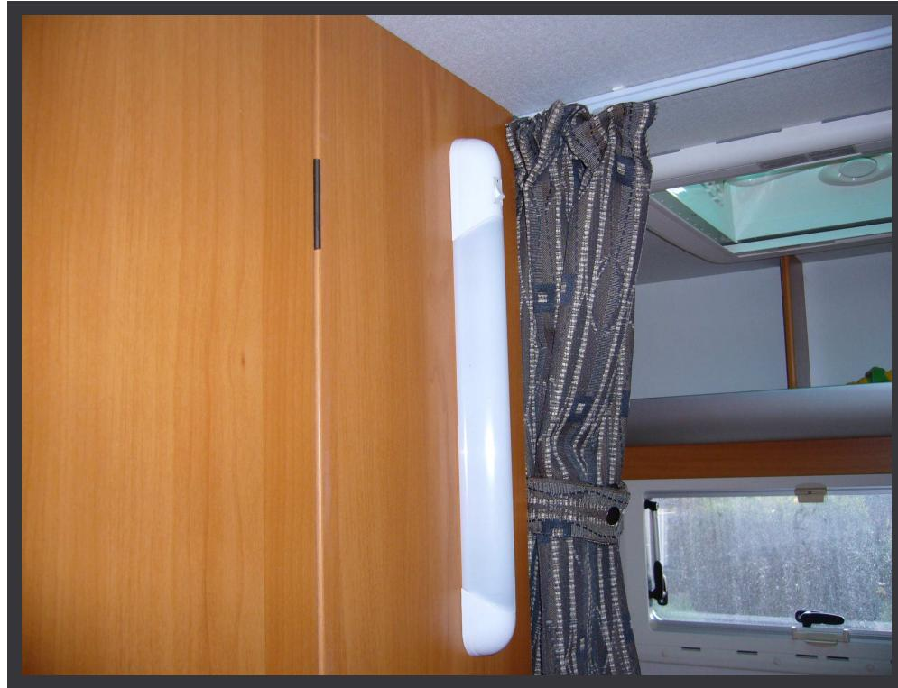
Per alimentare la lampada è bastato forare la parete per entrare in bagno all' interno del vano chiuso con un pannellino di legno sopra lo specchio, staccare i fili che alimentano l' attacco 12v (che nel mio camper nessuno usa), e collegare i fili della plafoniera.
