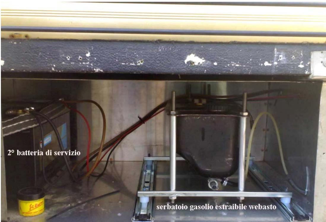
**2° batteria di servizio con annessi cavi di collegamento
