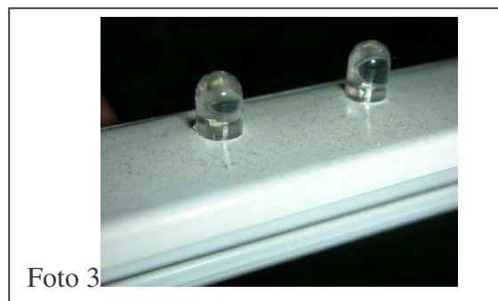
Una volta forata tutta la lunghezza da utilizzare, ho infilato i led nei fori facendone fuoriuscire verso l'esterno la parte radiante (foto 4)
