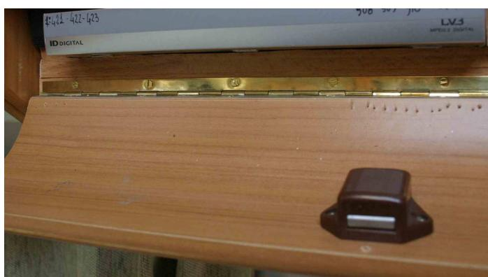
Qui potete vedere il particolare della chiusura, assolutamente originale Mobilvetta, e della mappa di chiusura dello sportello in metallo ottonato fissata con piccole viti in ottone 2,5 x 30 mm
