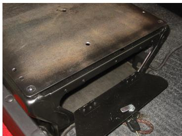
ho utilizzato due piastre di acciaio di spessore 4 mm e dimensioni 45.5 x 46.5 cm. Come rinforzo per il bullone centrale ( $\varnothing$  14 mm con rondella elastica ondulata e dado autobloccante), ho sovrapposto due piastre dello stesso materiale e spessore di dimensioni 15 x 30 cm.
