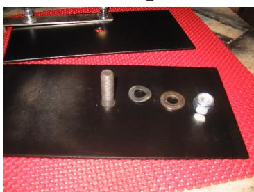
Il foro centrale non è nel centro delle piastre, ma spostato di 2 cm verso le mezzerie del veicolo: in questo modo quando il sedile è girato indietro viene a trovarsi 4 cm verso l'interno, agevolando sia l'abitabilità, sia la rotazione stessa del sedile, e il bracciolo interno non va a ridosso della portiera. Lo spazio di passaggio tra i due sedili rimane sostanzialmente lo stesso.
