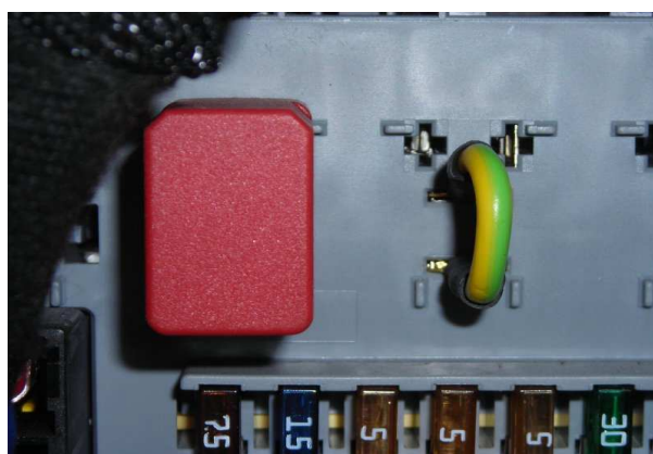
Foto 5: Inserito il ponticello al posto dei contatti 30 e 87 del relè
