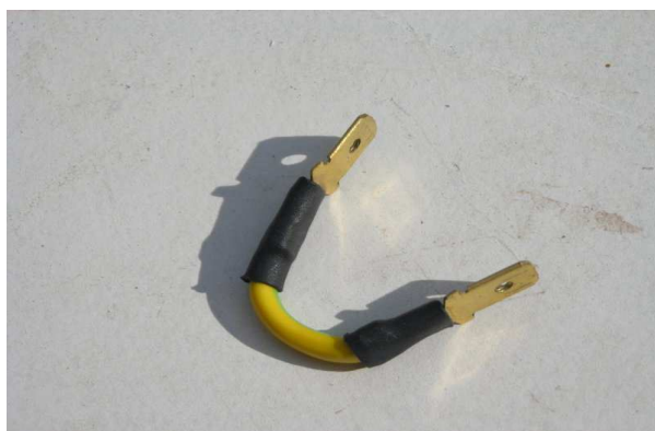
Foto 1: Ponticello pronto per l'installazione
