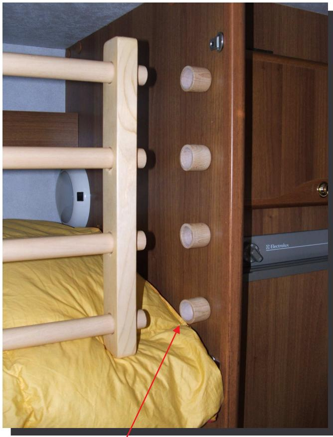
Quattro "terminali" sono fissati alla parete d'arresto, accogliendo le quattro aste e bloccandone ogni movimento. Nessun altro tipo di chiusura è necessario.
