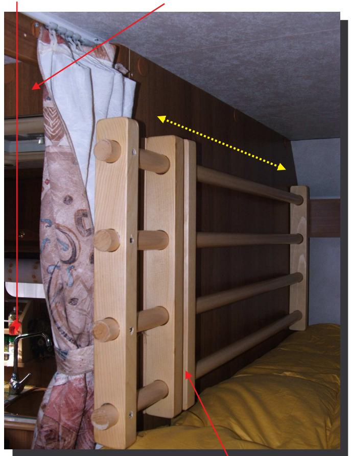
Due listelli paralleli sono fissati alla parete del bagno. Ho praticato dei fori di diametro leggermente superiore ai tondini di legno per permetterne lo scorrimento. Questa è la posizione di non utilizzo: la protezione è spinta completamente in fondo (verso la parete posteriore del mezzo).
