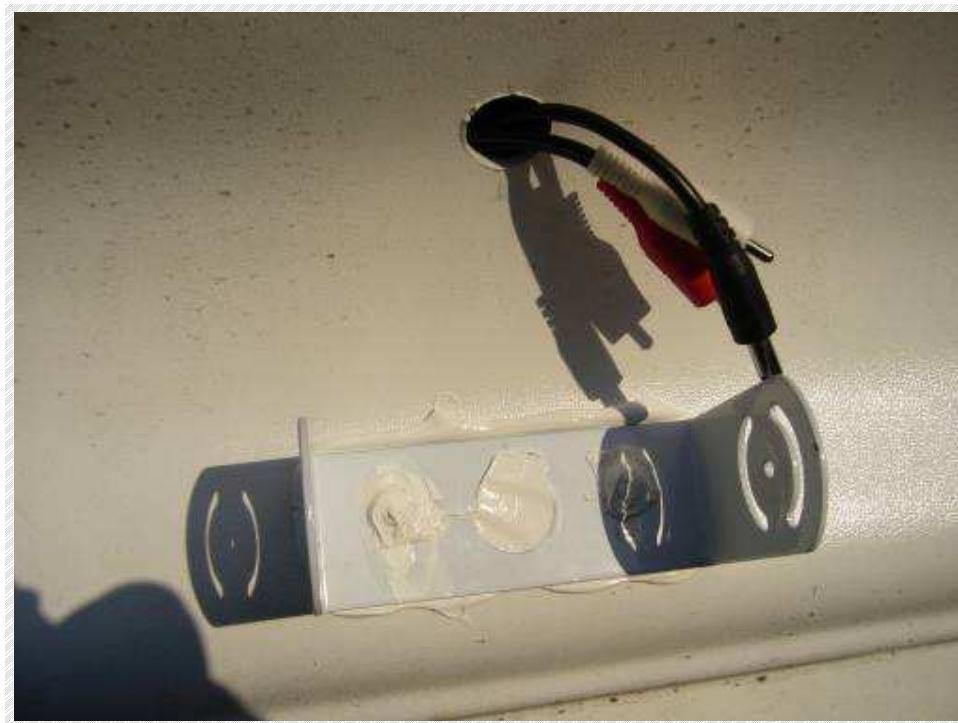
Montato la retrocamera e la sua copertura con le viti di serie che permettono la regolazione dell' inclinazione.
