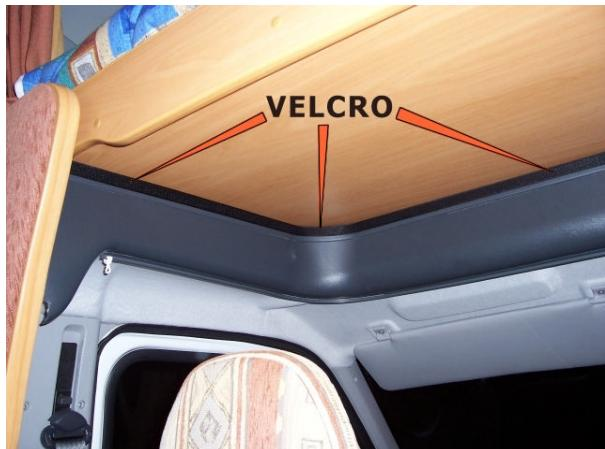
Ho applicato del VELCRO adesivo lungo il perimetro del "carter" di copertura del taglio-cabina
