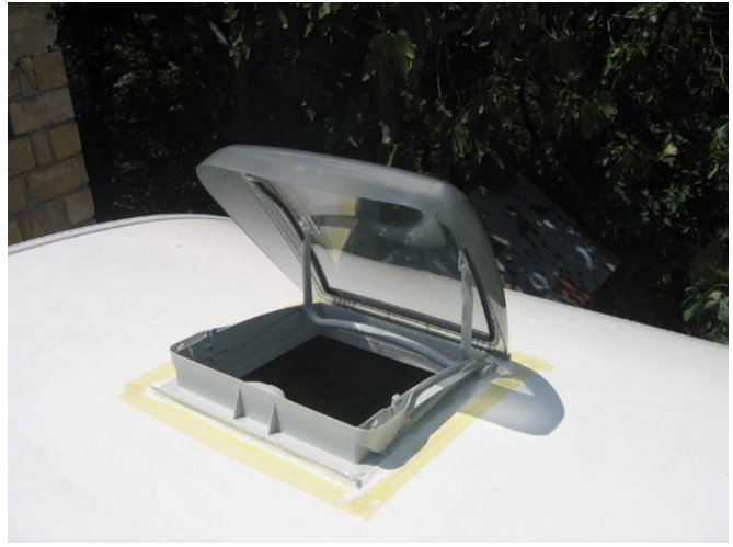
Figura 14 - applicazione del sikaflex 221
