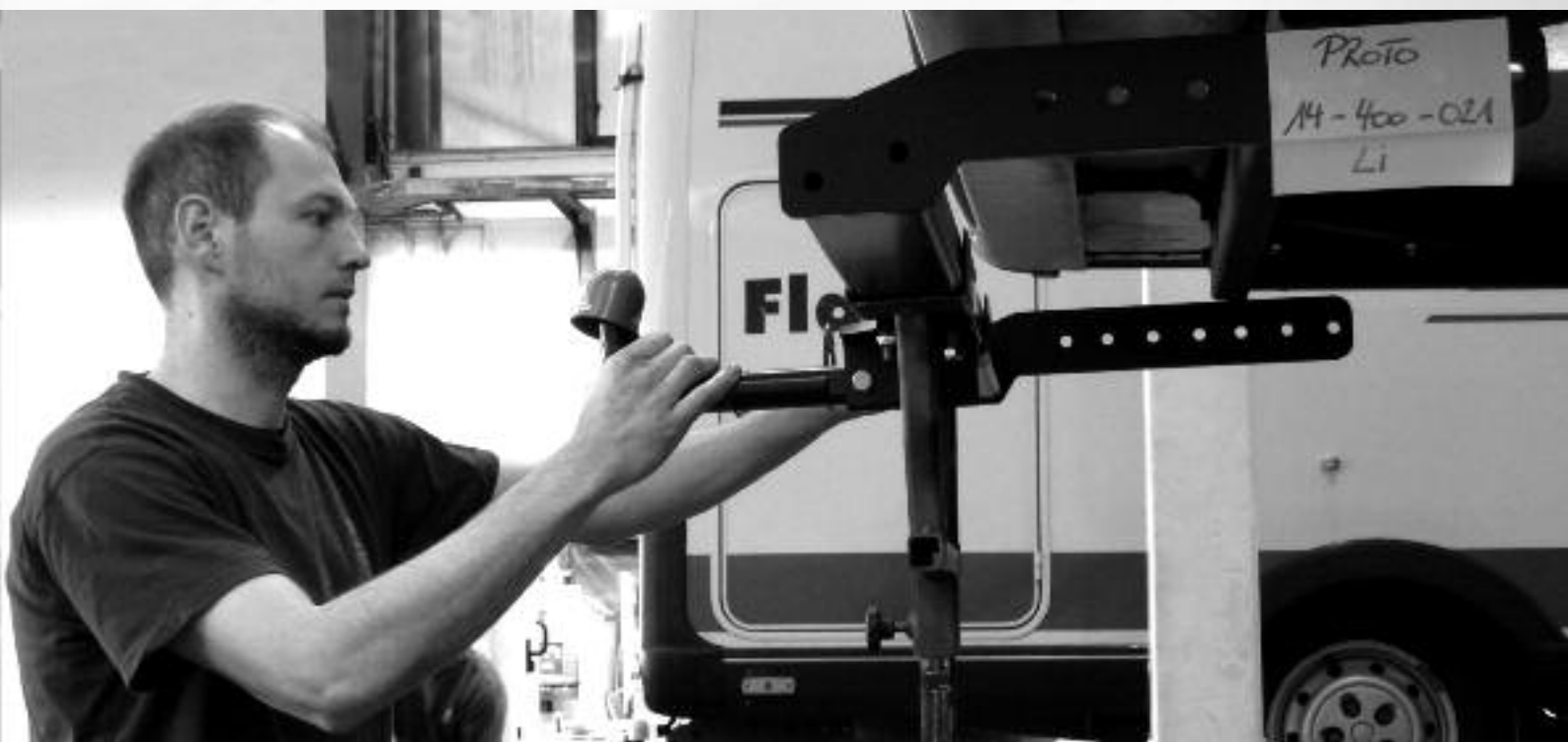
Anhängerkupplung mit Rahmenverlängerung für Anhängelasten bis 2 t
