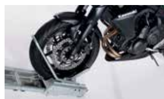
! Carrello ruota anteriore - la ruota anteriore viene posizionata tramite il supporto ribaltabile e la moto viene fissata con cinghie.
