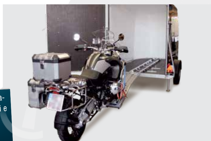
! Carrello ruota anteriore - la ruota anteriore viene posizionata tramite il supporto ribaltabile e la moto viene fissata con cinghie.
