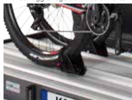
I Cunei ruota a chiusura rapida regolabili liberalmente
