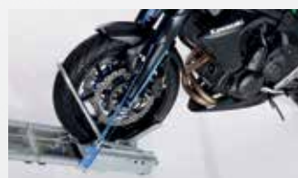
! Carrello ruota anteriore - la ruota anteriore viene posizionata tramite il supporto ribaltabile e la moto viene fissata con cinghie.
