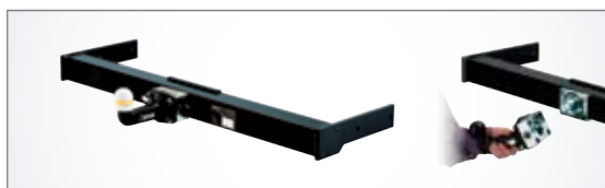
AHK MT 005 con sistema a sfera rimovibile
