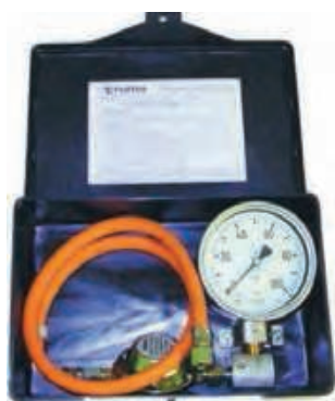
015 RP Apparecchio per la misurazione della pressione del gas in uscita dal regolatore.
