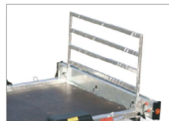
Rampa larga a tubi
