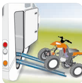
Due pezzi abbinati del Carry-Ramp per caricare Quad, carrozzine elettriche e sedie a rotelle
