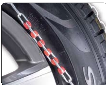
Sistema autotensionante basato su elastomeri termoplastici
