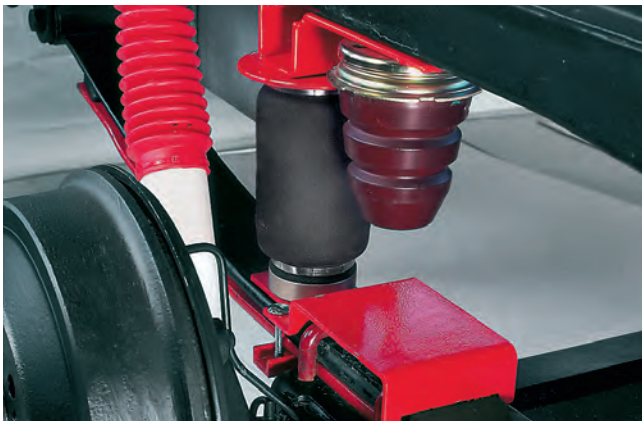
2-Balg-Anlagen aus dem „AirMaster“-Programm (Bild links) bieten besten Fahrkomfort bei geringeren Belastungsanforderungen bis max. 1.700 kg Hinterachslast. Die 4-Balg-Anlage (Bild rechts) verkraftet Hinterachslasten bis 2.000 kg.
