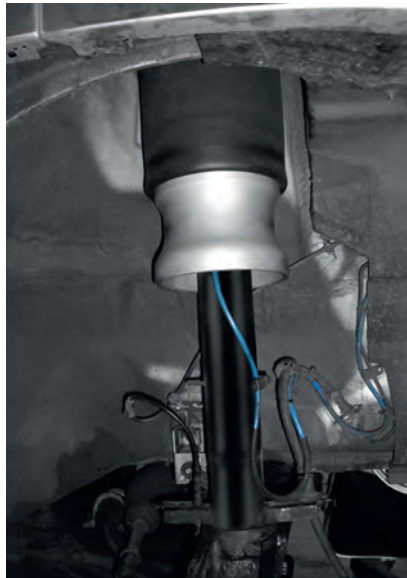
Die Vollluftfeder für die Vorderachse ermöglicht einen Federweg von bis zu 160 Millimeter.
