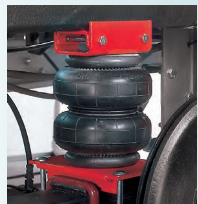
Sonder-Halter: Ducato mit mittiger Montage der Halter.
