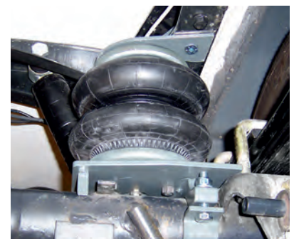
2 Balg-Anlage mit Doppelfaltenbälge für den Iveco Daily 35C-50C (Baujahr ab 2006)
