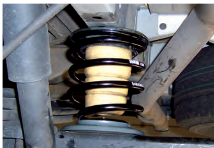
Montagebeispiel: Ford Transit mit eckiger Achse
