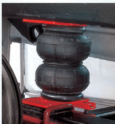
Standard-Halter: Ducato mit nach innen versetzten Haltern.
