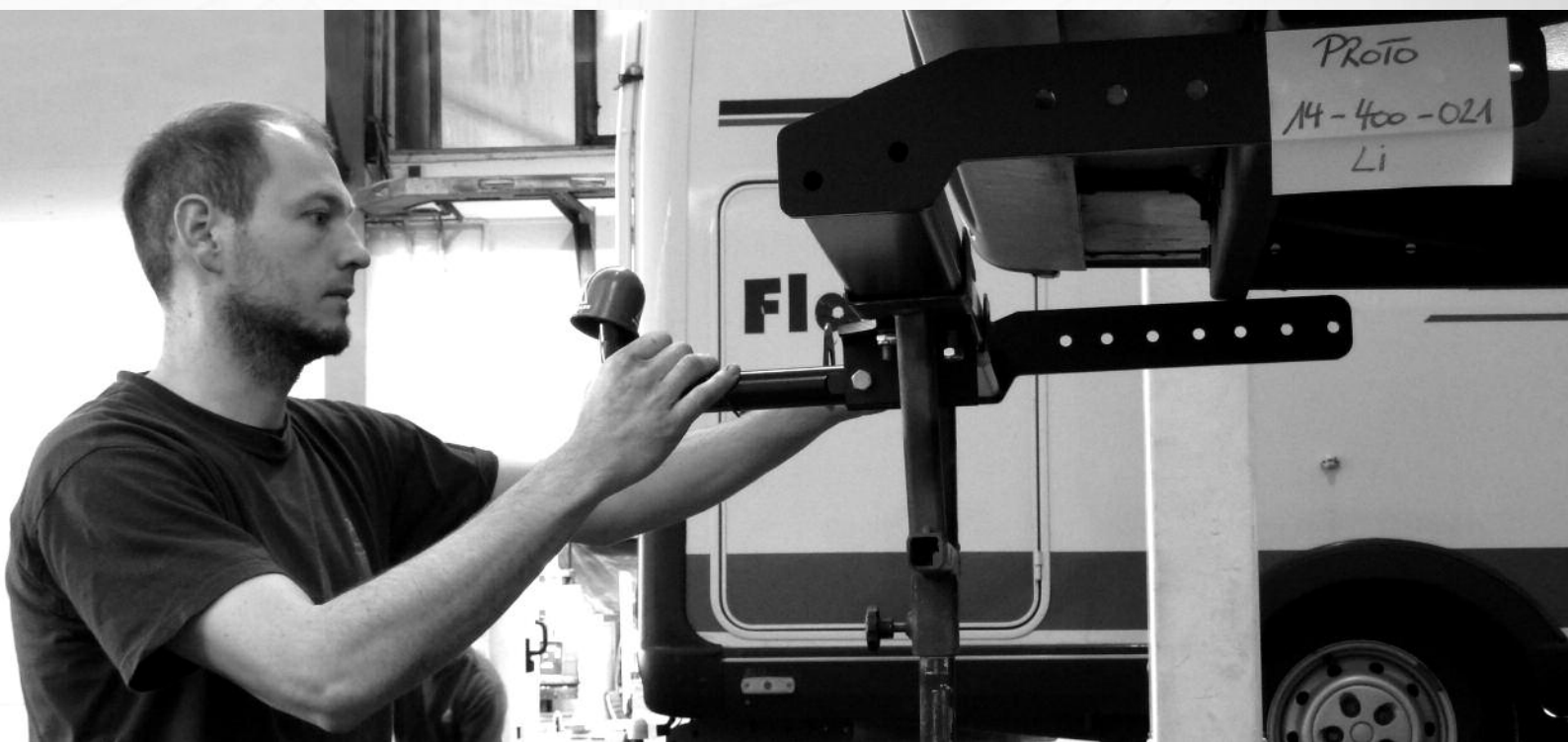
Anhängerkupplung mit Rahmenverlängerung für Anhängelasten bis 2 t
