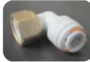
E30404 Raccordo terminale a gomito 90° per tubo Ø 12 mm filetto femmina 1/2"
