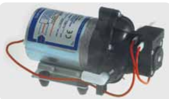
E30000 Pompa Shurflo autoadescante, 12 V, assorbimento 3 Amp, portata 7 l/minuto
