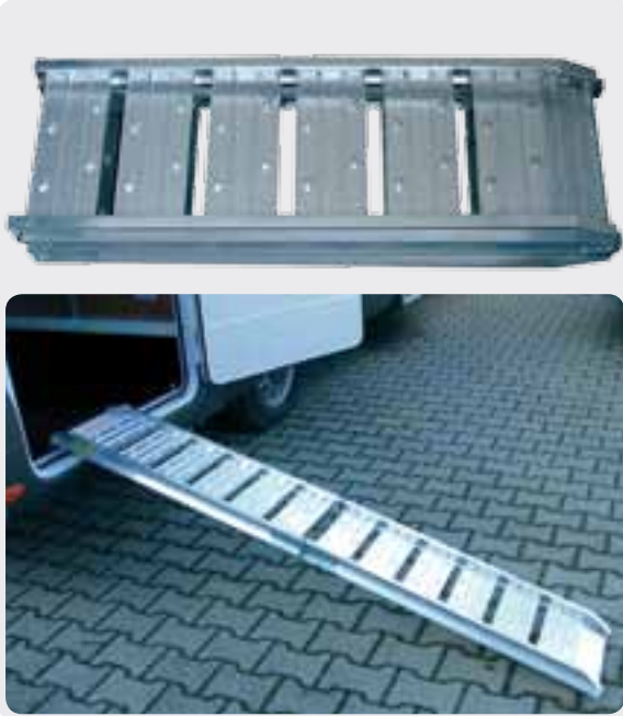
K55242 Rampa in alluminio per caricare moto nel garage. Dim aperta 2000 x 230 mm, chiusa 1000 x 230 mm, peso 5 kg, portata 200 kg
