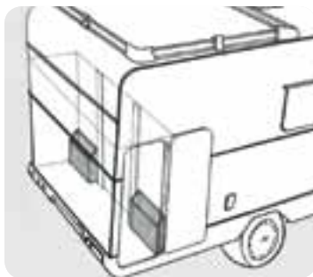
K55265 Contenitore in plastica per interno garage Dim. 470 x 170 x 360 mm
