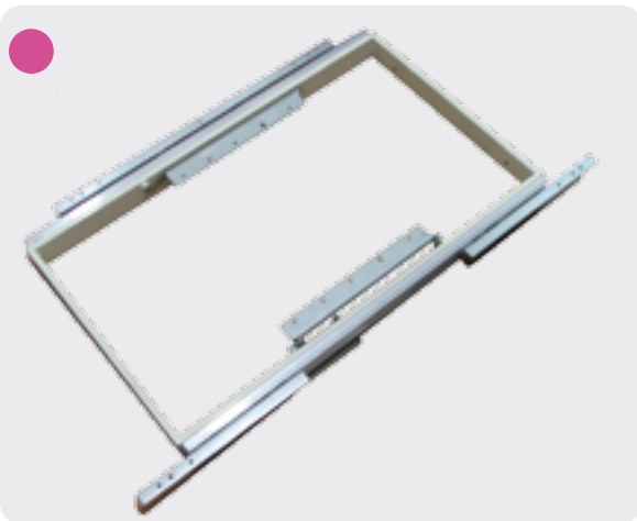
B15401 Meccanismo in acciaio che permette di allungare il tavolo con un elemento centrale che si solleva oppure si abbassa automaticamente tirando o spingendo un elemento laterale del tavolo. 5 kg
