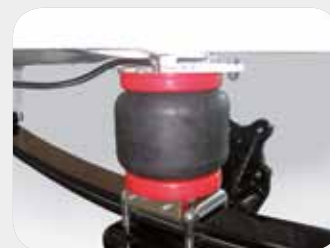
■ Einbausituation AL-KO Air Top X250
