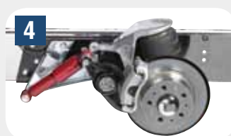
■ Elektronisch geregelte Luftfederung
