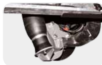
■ Montagebild: Zusatz-Luftfeder für RENAULT Master
