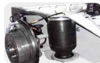
■ Montagebild: Zusatz-Luftfeder für Euro-Chassis, Typ X250
