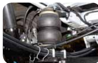
■ 6"-Doppelfaltenbalg im eingebauten Zustand
