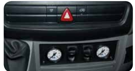
■ Fahrzeugspezifisches Bedienteil im Führerhaus
