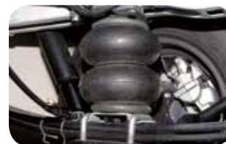
■ 8"-Doppelfaltenbalg im eingebauten Zustand
