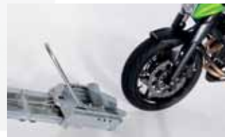
| Elektroseilwinde mit Funkfernbedienung (Montageposition kann abweichen)
