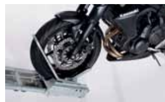
| Vorderradschlitten - Vorderrad wird einfach auf die Wippe geschoben und das Motorrad festgurtet.
