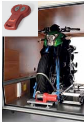
| Elektroseilwinde mit Funkfernbedienung (Montageposition kann abweichen)
