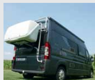
I Stauraumerweiterung mit Gepäckbox Ultra 500 Volumen 500 L Gewicht 17 kg Abmessung 1470x700x530 mm
