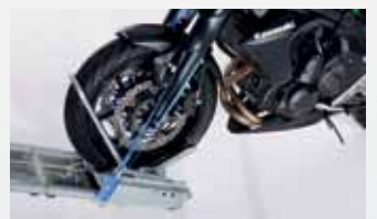
| Vorderradschlitten - Vorderrad wird einfach auf die Wippe geschoben und das Motorrad festgurtet.
