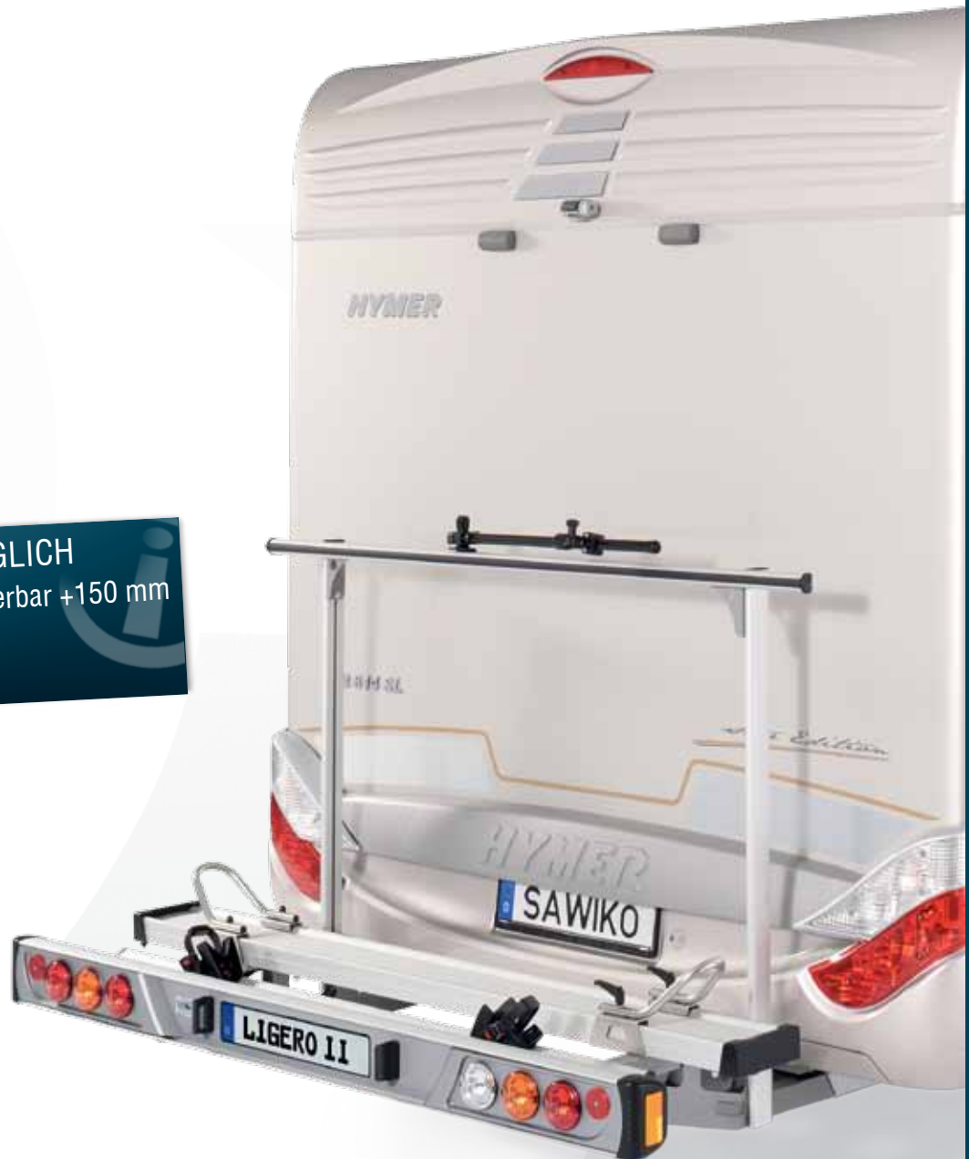
I Ausführung LIGERO II 1 Roller + 1 Fahrrad mit Sonderzubehör Motorradwanne Modell 3000 und Fahrradschiene mit Ratschen-Schnellverschluß
