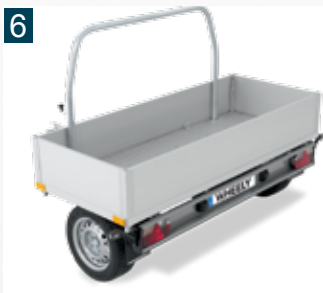
6 Aluminium Bordwände 300 oder 600 mm Höhe
