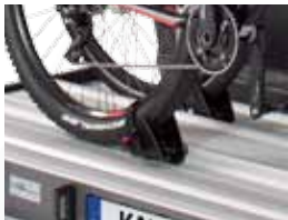
Stufenlos verstellbare Radschale mit Ratschenschnellverschluss
