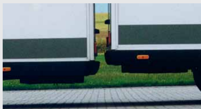
I Die Zusatz-Luftfeder hebt das Fahrzeugheck deutlich an und sorgt damit für bessere Fahrsicherheit und erhöhten Komfort
