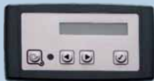
Elemento di comando Dimensioni: L x H x P = 14,0 x 7,1 x 3,5 cm
