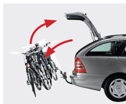
Funzione basculante Pratico accesso al bagagliaio con il portabici inclinato.
