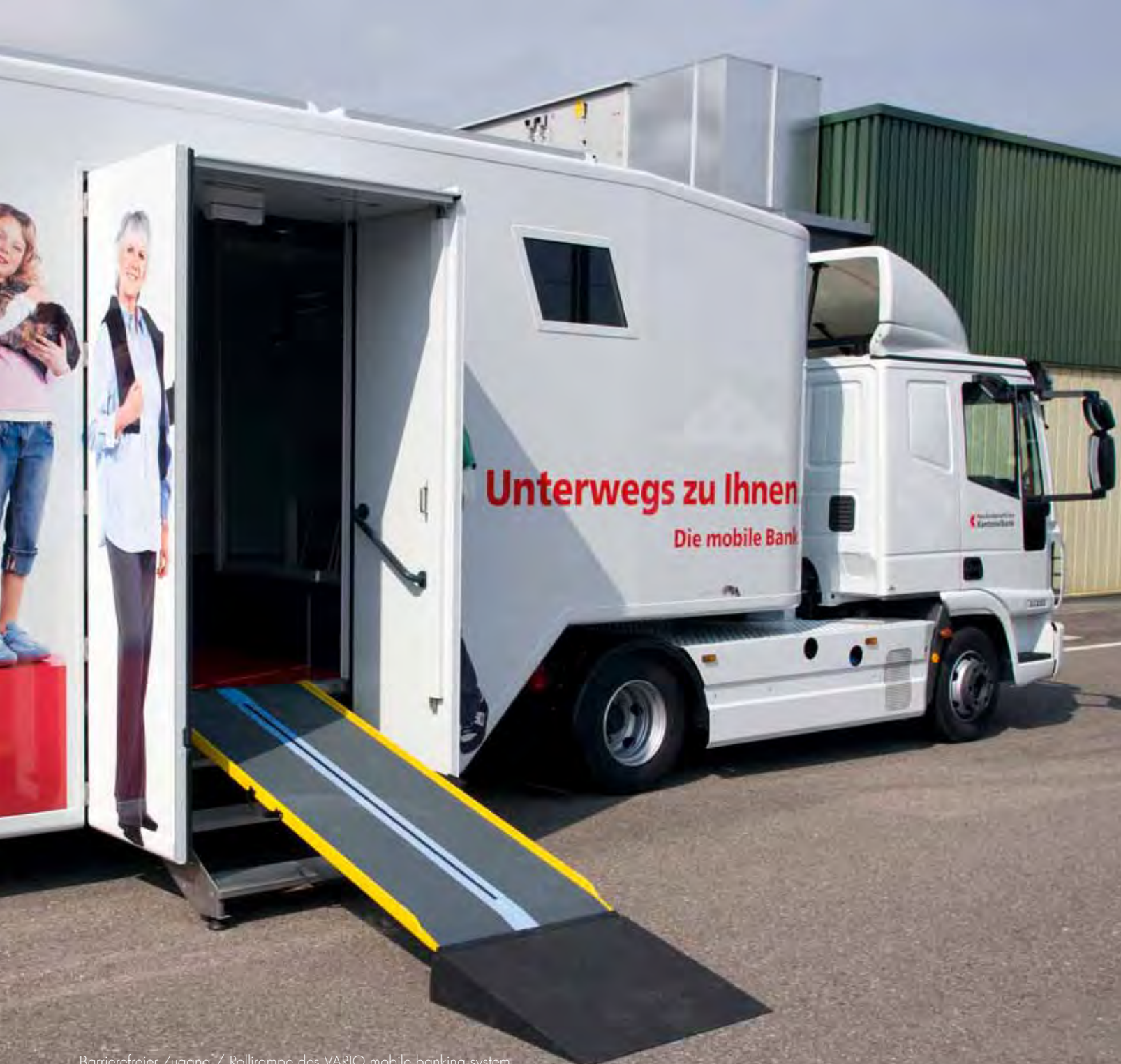
Barrierefreier Zugang / Rollrampe des VARIO mobile banking system
