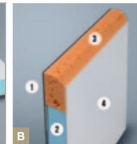
Pareti esterne in vetroresina antigrandine. Estruso plastico ad alta densità e Styrofoam® in tutte le pareti: maggiore isolamento acustico e termico, eliminano le infiltrazioni d'acqua all'interno del veicolo. Laminato plastico interno: impedisce il contatto tra interno e esterno. Wood free.
