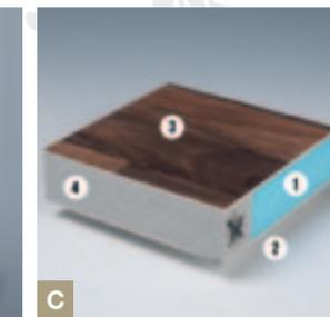
Pavimento in Styrofoam® con copertura inferiore e superiore in vetroresina per maggiore isolamento termico e resistenza meccanica. Spessore del pavimento 54 mm, maggiore resistenza strutturale e massima resistenza agli urti.
