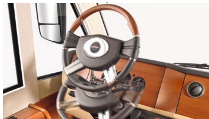
Volante in pelle/legno ribaltabile in avanti per poter utilizzare comodamente il sedile del guidatore in posizione sdraiata
