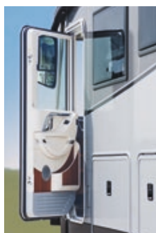
Porta di guida con accesso ribassato, doppia chiusura di sicurezza
