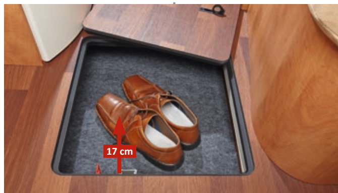
Vano di stivaggio nel doppio pavimento, accesso dall'interno tramite sportello a pavimento
