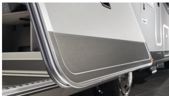
Sportelli del garage con ammortizzatori a gas, sistema di doppia guarnizione, guarnizione esterna a prova di spruzzi e getti d'acqua, cerniera della porta interna invisibile
