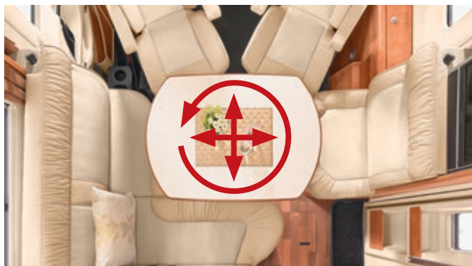
Tavolo dell'abitacolo scorrevole in due sensi e ruotabile di 360°
