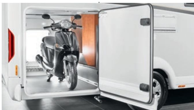
Garage per scooter posizionato molto in basso e ampia altezza interna, due porte del garage, guide di ancoraggio per i bagagli
