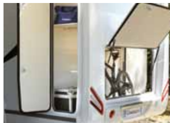
Gavone passante esterno con 2 portelloni d'accesso su entrambi i lati del camper (o 3 a seconda del modello), con illuminazione.
