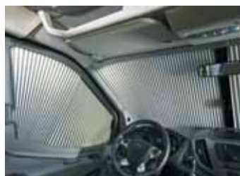
Queste tende isotermitiche scorrevoli proteggono dalla luce del giorno, da sguardi indiscreti e da eccessi di temperatura grazie al materiale multistrato (modello Flash).
