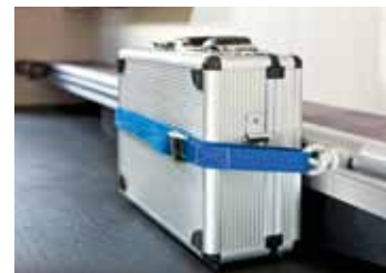
Il gavone è provvisto di guide e ganci per fissare in maniera solida bici o scooter (finitura Welcome).
