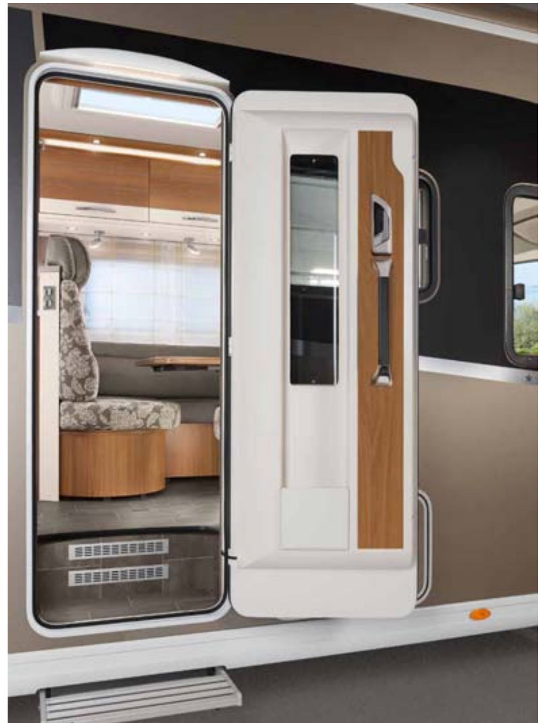
+ Extrabreite Aufbau-tür mit elektrischer Zuzieh-hilfe (6)
