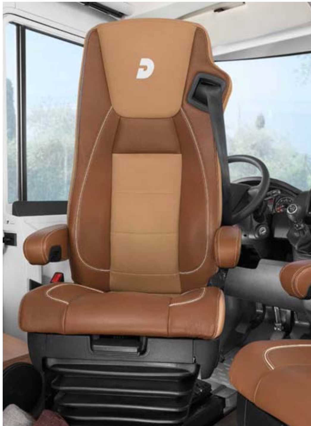
+ Luftgefederter Pilotensitz von SKA (Option) (7)
