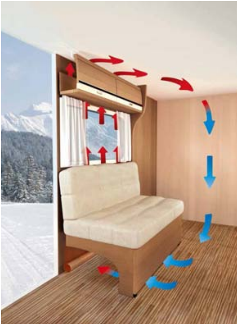
+ Das AirPlus System verhindert die Bildung von Kondenswasser
