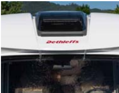
+ Wasserkanäle führen Regenwasser gezielt auf Frontscheibe und Heckbauch ab
