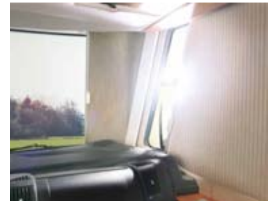
+ Die serienmäßigen Fahrerhausjalousien verdunkeln und isolieren zugleich
