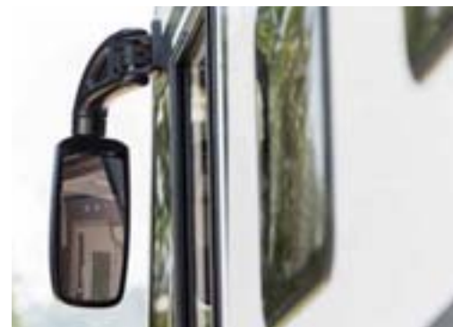
+ Die hängend montierten Reisebus-Rückspiegel sichern einen ungestörten Rundumblick. Sie sind elektrisch verstellbar und beheizt
