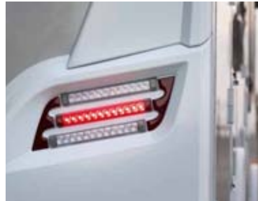
+ Reparaturfreundlich: das mehrteilige Heck mit stromsparenden LED-Rückleuchten
