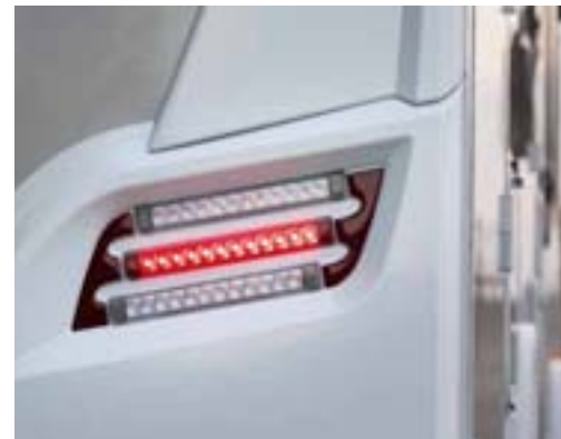
+ Reparaturfreundlich: das mehrteilige Heck mit stromsparenden LED-Rückleuchten
