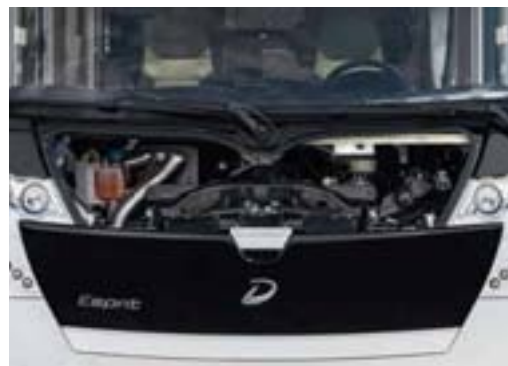
+ Über die besonders große Motorraumöffnung lassen sich Servicearbeiten komfortabel durchführen
