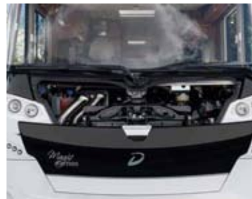
+ Große Motorraumöffnung, über die alle service-relevanten Teile gut erreicht werden können
