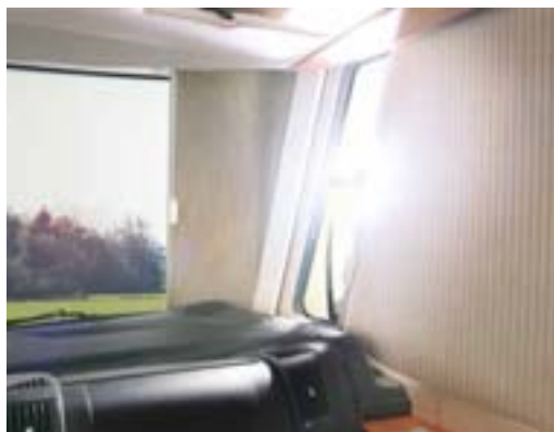
+ Die serienmäßigen Fahrerhausjalousien verdunkeln und isolieren zugleich
