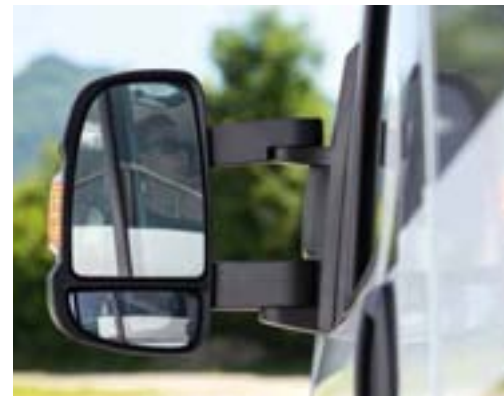
+ Die Rückspiegel sind elektrisch verstell- und beheizbar
