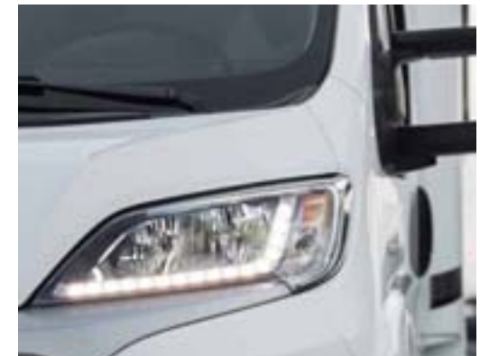
+ Sieht schick aus und bringt Sicherheit: LED-Tag-fahrlicht
