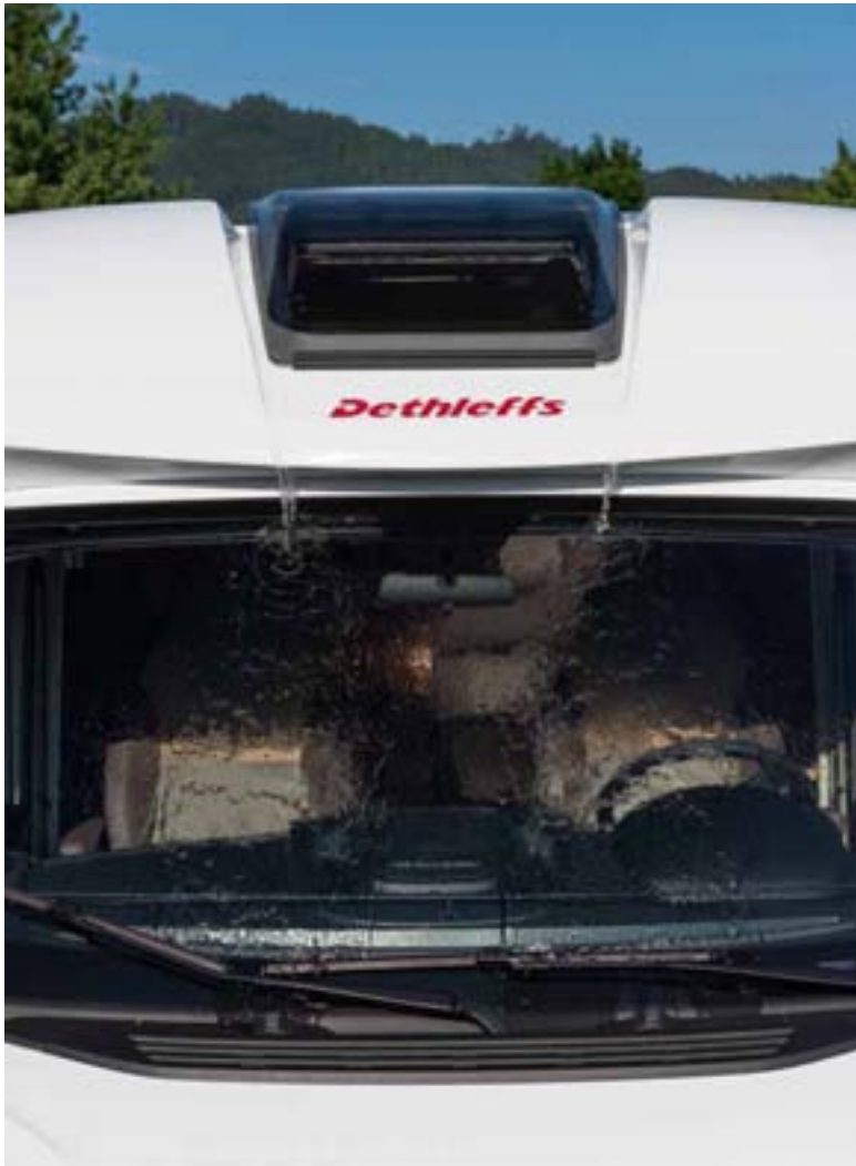
+ Auf dem Dach gesammeltes Wasser wird gezielt abgeleitet
