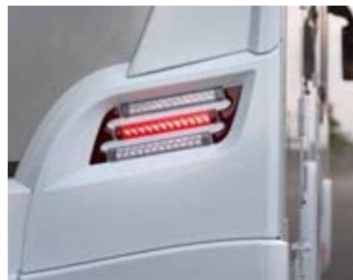
+ Reparaturfreundlich: das mehrteilige Heck mit stromsparenden LED-Rückleuchten
