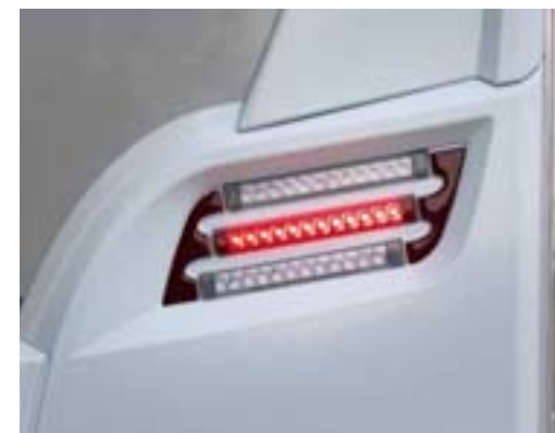
+ Reparaturfreundlich: das mehrteilige Heck mit stromsparenden LED-Rückleuchten
