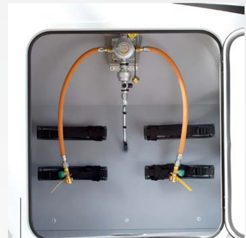
Vano del gas con opzione DuoControl e EisEx.
