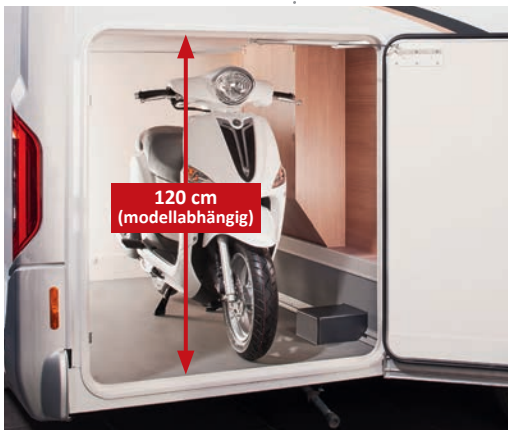
Abgesenkte Roller-/Fahrradgarage, beladbar bis 250 kg
