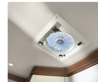
9403 Oblò con regolazione termostatica (cucina)
