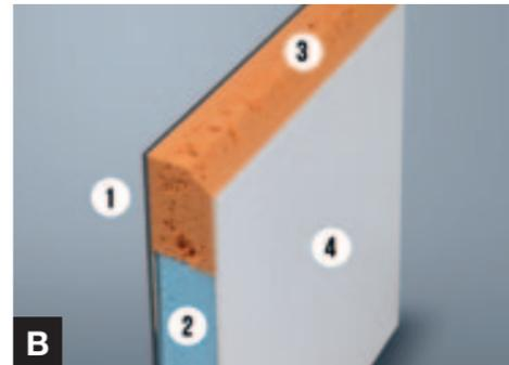
Pareti esterne in vetroresina antigrandine. Estruso plastico ad alta densità e Styrofoam® in tutte le pareti: maggiore isolamento acustico e termico, eliminano le infiltrazioni d'acqua all'interno del veicolo. Laminato plastico interno: impedisce il contatto tra interno e esterno. Wood free.
