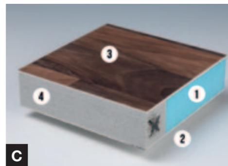
Pavimento in Styrofoam® con copertura inferiore e superiore in vetroresina per maggiore isolamento termico e resistenza meccanica. Spessore del pavimento 54 mm, maggiore resistenza strutturale e massima resistenza agli urti.
