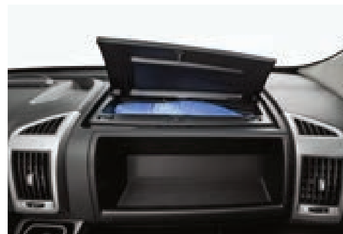
Vano termico nel cruscotto
