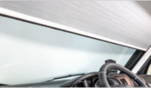
Tenda plissettata a movimento elettrico con pulsante di azionamento alla sinistra del cruscotto e parabrezza esterno con resistenze termiche (optional).
