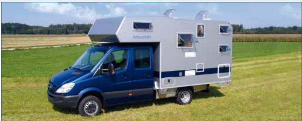
Das Reisemobil BJ 330 kann mit einer Wechsellvorrichtung ausgestattet werden, die das einfache Auf- und Absetzen der Wohnkabine ermöglicht. Alternative Aufbauten zur Wohnkabine wie Container oder Pritsche sind lieferbar.
