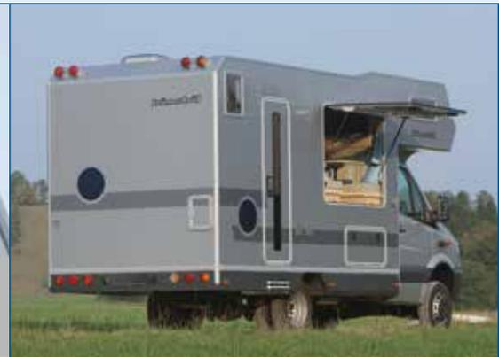
Das Reisemobil HD 420 kann mit einer Wechsellösung ausgestattet werden, die das einfache Auf- und Absetzen der Wohnkabine ermöglicht. Alternative Aufbauten zur Wohnkabine wie Container oder Pritsche sind lieferbar.
