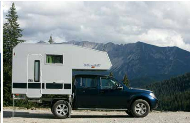
Trotz unseres Konstruktionsprinzips, die Wohnkabine direkt auf dem Fahrgestell aufzusetzen, kann die Pritsche des Originalfahrzeugs alternativ zur Wohnkabine weiter benutzt werden. Mit der zur Wechsellpritsche umgerüsteten Originalpritsche wird im Handumdrehen aus dem Fahrgestell wieder ein vollwertiger Pritschenwagen.
