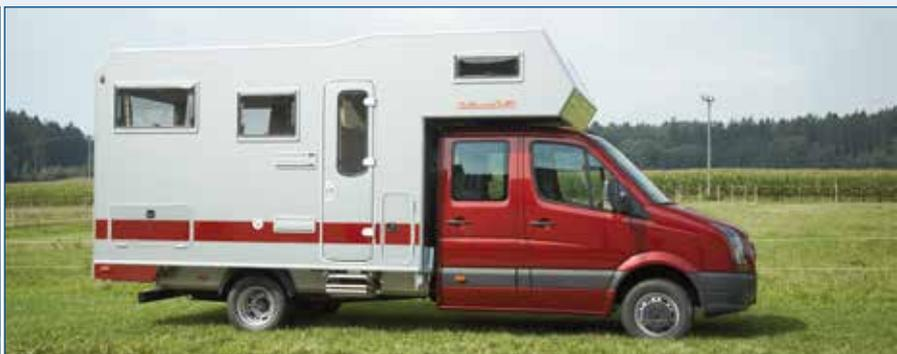
Das Modell LB 365 für MB Sprinter gibt es mit Einfach- wie auch mit Doppelkabinenfahrzeug. Und in beiden Fällen kann das Fahrzeug mit einer Wechselvorrichtung ausgestattet werden, die das einfache Auf- und Absetzen der Wohnkabinen ermöglicht. Alternative Aufbauten zur Wohnkabine wie Container oder Pritsche sind möglich.
