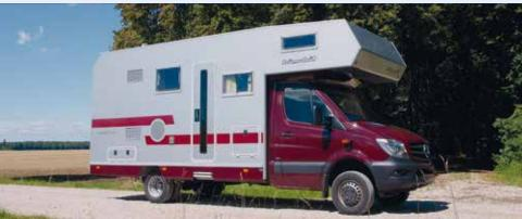
Das Modell ST 702 ist auf dem Iveco Daily Fahrgestell aufgebaut. Das Reisemobil ST 702 kann mit einer Wechselvorrichtung ausgestattet werden, die das einfache Auf- und Absetzen der Wohnkabine ermöglicht. Alternative Aufbauten zur Wohnkabine wie Container
