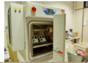
Test specifici in camera climatica in fase di ricerca e sviluppo e prototipazione per verificare la tenuta, la durata e le performance dei materiali selezionati a temperature estreme caldo/freddo.
