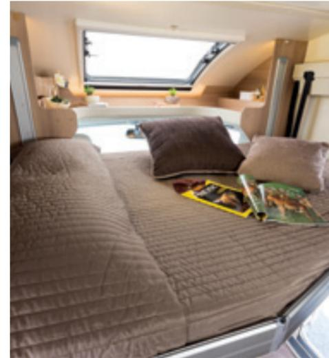
Modelli con letto basculante elettrico. Massima abitabilità interna con altezza, dal letto chiuso a terra di 1900 mm, meccanismo elettrico, bloccabile ad ogni posizione, che lascia la dinette e la cucina sempre fruibili, grande stabilità.
