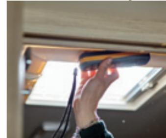
Test di impermeabilizzazione contro le infiltrazioni al 100% dei veicoli usciti di produzione, prima della consegna.
