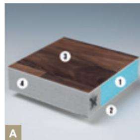
Pavimento in Styrofoam® con copertura inferiore e superiore in vetroresina per maggiore isolamento termico e resistenza meccanica. Spessore del pavimento 54 mm, maggiore resistenza strutturale e massima resistenza agli urti.
