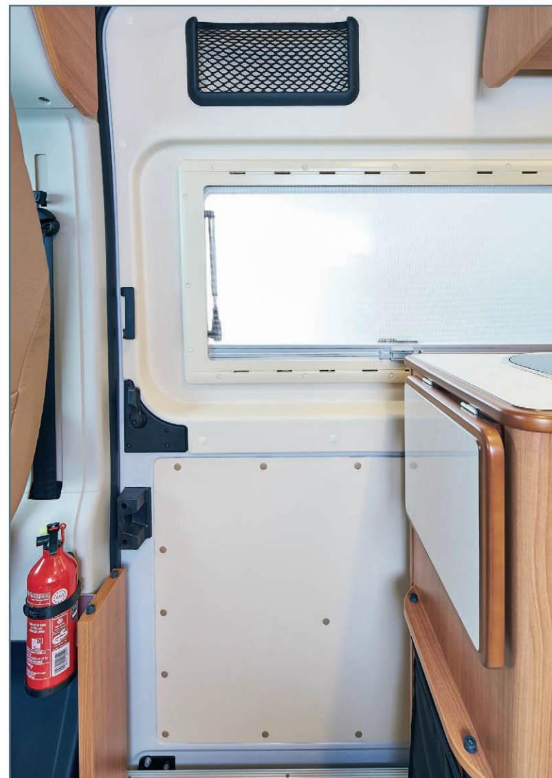
HABILLAGE THERMO COMPLET PORTE LATÉRALE ET POIGNÉE DE MANIPULATION
