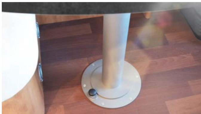
Lussuoso tavolo dell'abitacolo a 360°, girevole e scorrevole in due sensi tramite pedale
